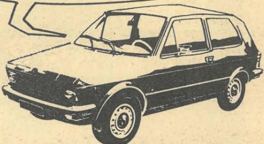
4 CV (900 cm<sup>3</sup>). Traction avant, 4 roues indépendantes. Culasse en alliage léger. Freins à disque à l'avant. Sièges AR rabattables. Hayon. Le tout en 3,49 m. **Yugo 45**
